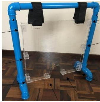
Figura 4: As setas indicam 10 presilhas de acrílico utilizadas para manter o distanciamento entre as placas.
